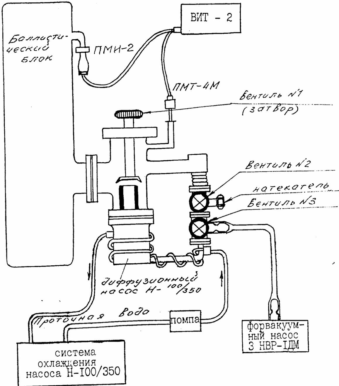
Рис. 2. Вакуумная система ГБЛ-П
