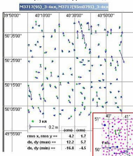
Для сравнения рядом на рис. П4.6б, взятом из приложения 4 показаны остаточные расхождения координат при использовании для преобразования цифровой модели для всей трапеции М37. Общий характер поведения остаточных расхождений (с учетом разницы
