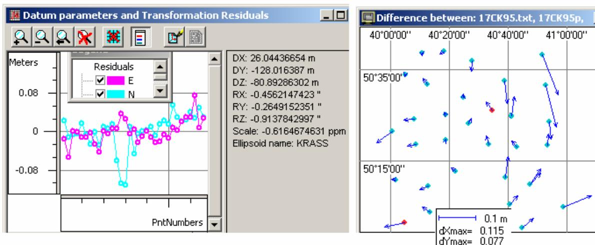
Для трапеции М3717 ортогональное преобразование дает заметно лучшие результаты. Как видно на рис. П6.5 остаточные уклонения лишь для двух пунктов 2 класса близки к 10 см. Для большинства остальных пунктов они заметно меньше.
