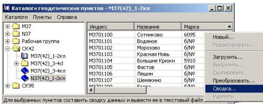
Рис. П5.4 Вид окон при составлении списка координат по команде «Сводка»
