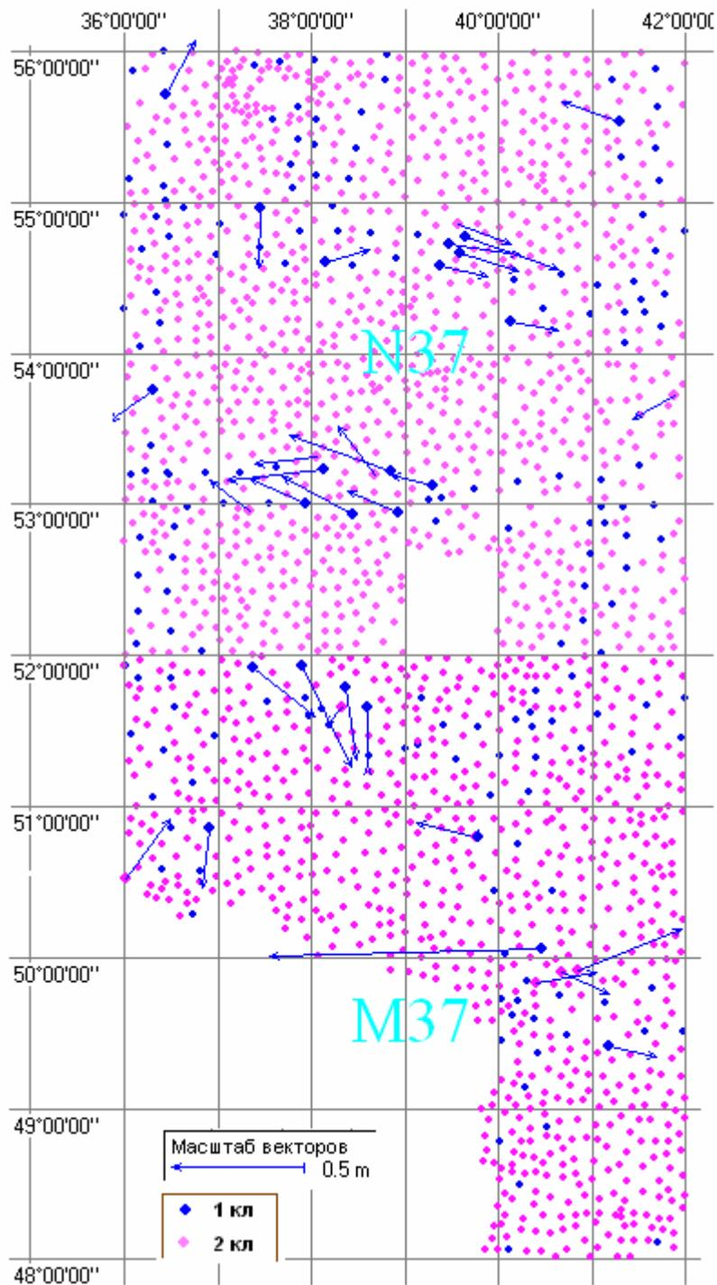
**Рис П4.3 Пункты ГГС 1, 2 и 3 классов, использованные при построении цифровой модели преобразования координат из СК42 в СК95 на трапецию М37 и вектора остаточных расхождений в положениях пунктов, данных в каталогах СК95 и полученных преобразованием по цифровой модели**
