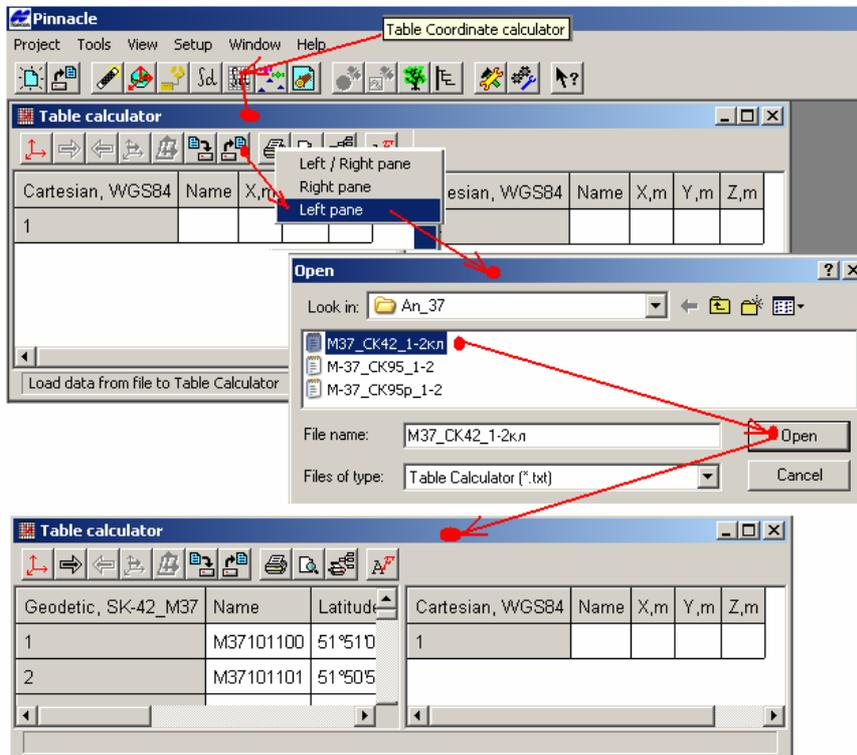
Рис. П5.5 Ввод координат СК-42 в левую панель из файла М-37\_СК-42\_1-2.
