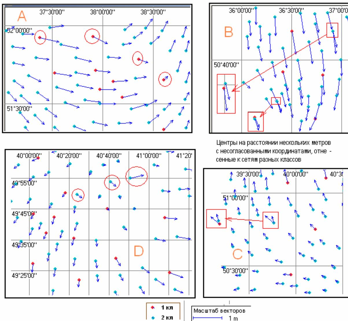
Рис. Пб.3а. Определение параметров преобразования для трапеций М3702 и М3703
