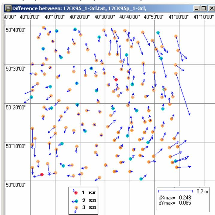
Рис. П4.6б. Остаточные расхождения координат п-тов 3 класса при преобразовании координат по цифровой модели.
