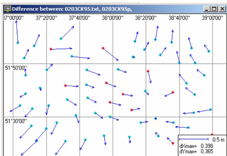
Рис. Пб.4. Остаточные уклонения координат. Трапеция М3702
