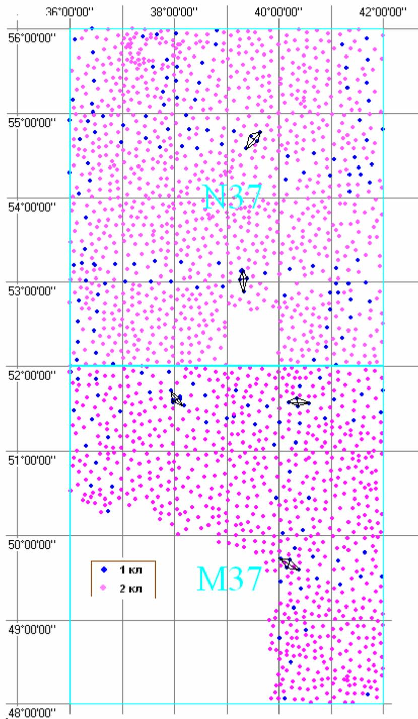
Рис П4.2 Пункты ГГС 1 и 2 классов, отображенные при построении цифровой модели преобразования координат из СК42 в СК95 на трапеции М37 и N37
